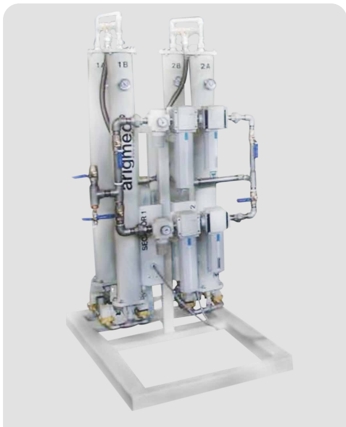
Sistema de tratamiento y secado de aire
